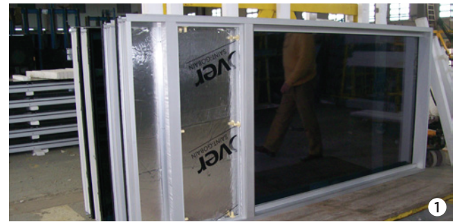
1. Colocación del panel Curtain Wall en taller.
